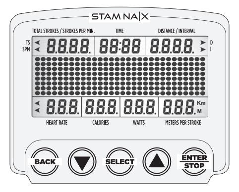
**POWER ON:** Move the handlebar or press any button.
